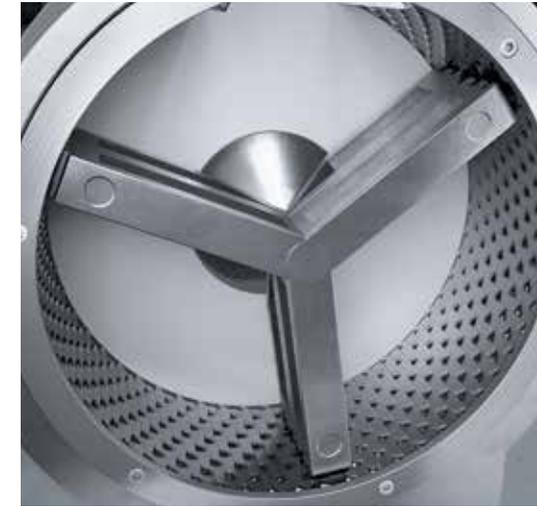
En raison de la forme de ses perforations, la tôle perforée CONIDUR® se prête notamment à une utilisation dans des broyeurs.
